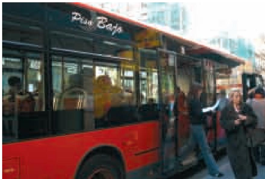
adaptación que han de realizar estos vehículos aparece detallada en los criterios técnicos fijados por el IMSERSO, a través del CEAPAT, y son, entre otros, la ausencia de escalones de acceso, espacios para sillas de ruedas, diversas particularidades en los mecanismos de solicitud de parada e incorporación de rampa para facilitar el acceso a las personas con movilidad reducida.
